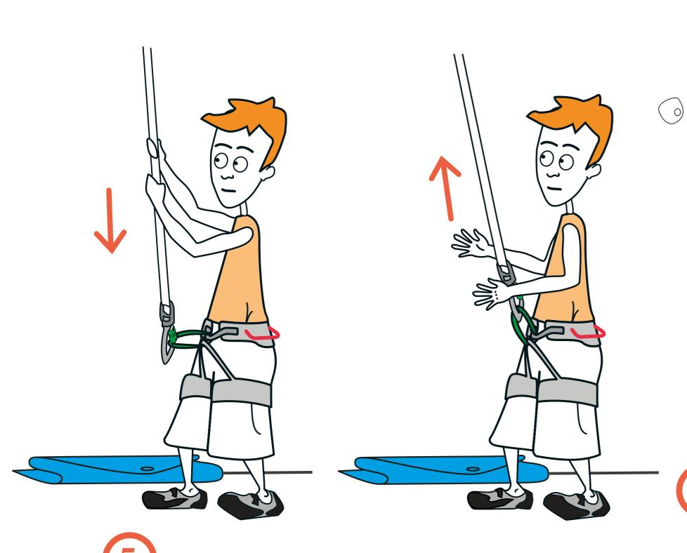
JE TIRE LA SANGLE À DEUX MAINS POUR VÉRIFIER SON BON FONCTIONNEMENT JE FAIS UN ESSAI À 1M DU SOL POUR TESTER LA CHUTE ET LA VITESSE D'ENROULEMENT. C'EST BON, JE PEUX GRIMPER!
