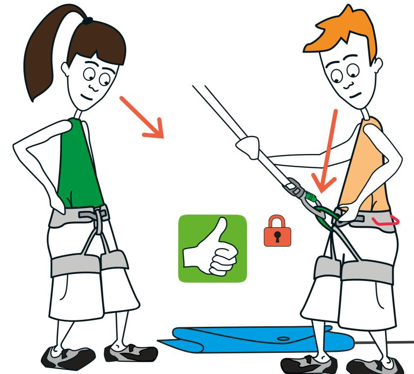
JE FAIS UN ESSAI POUR TESTER LA CHUTE ET LA VITESSE D'ENROULEMENT À 1M DU SOL. C'EST BON, JE PEUX GRIMPER!
